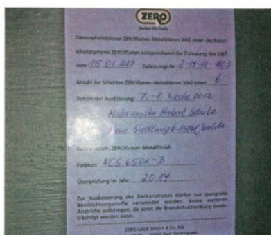
6 Vorgeschriebene Kennzeichnung eines eingesetzten reaktiven Brandschutzsystems. (Fotos: Geburtig)
