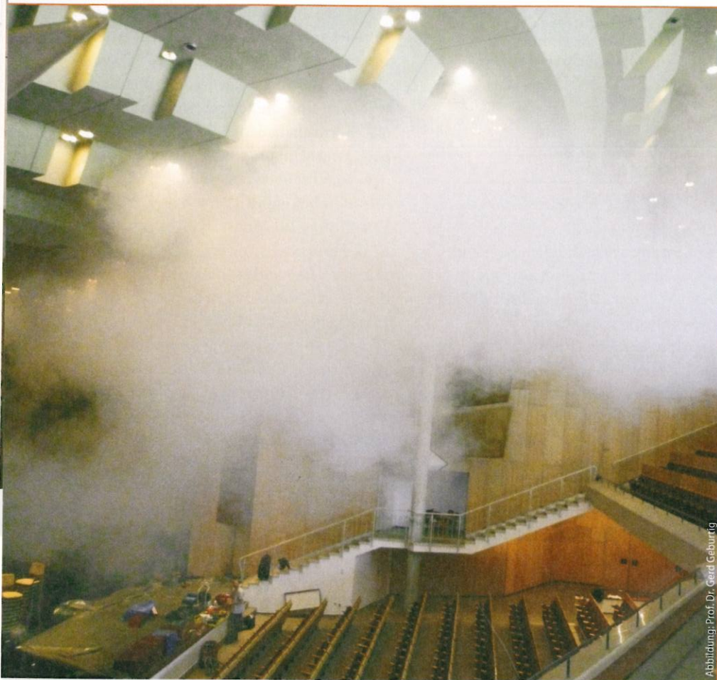
Abb. 4: Durchgeführter Rauchversuch im Zuschauerraum
